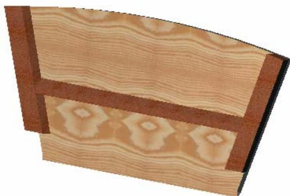
*Рис.10. Транец. Накладку под мотор следует устанавливать после монтажа банок.*
