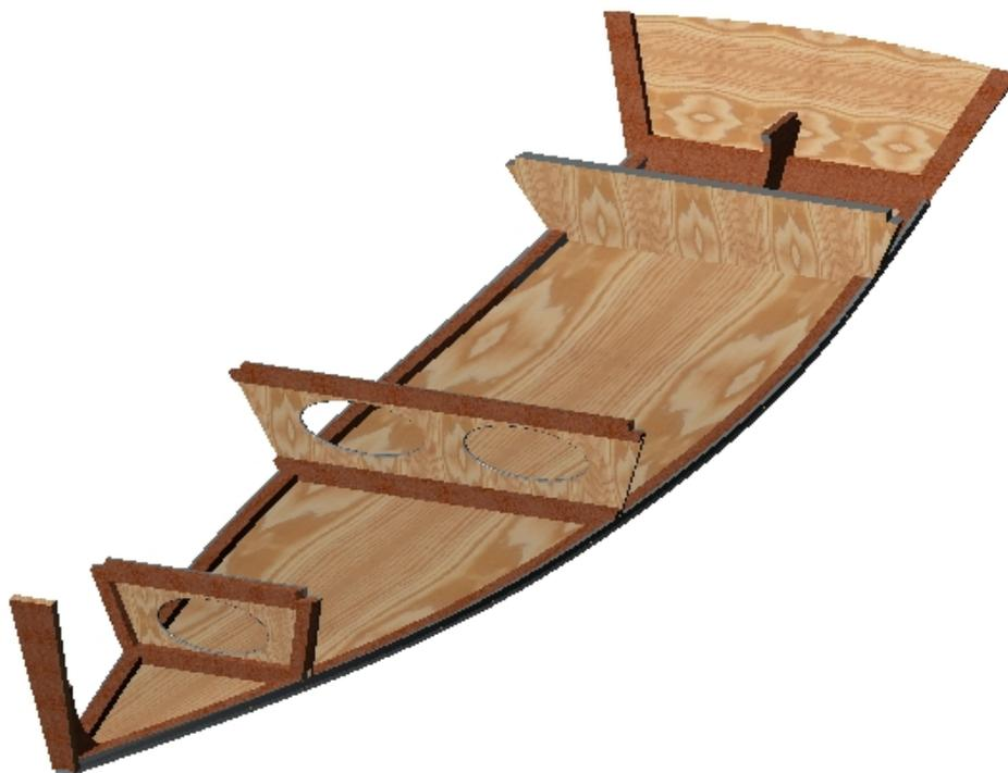
*Рис.14. Установка переборок. Переборки крепятся к флорам на закладке с помощью эпоксидного клея и саморезов.*
