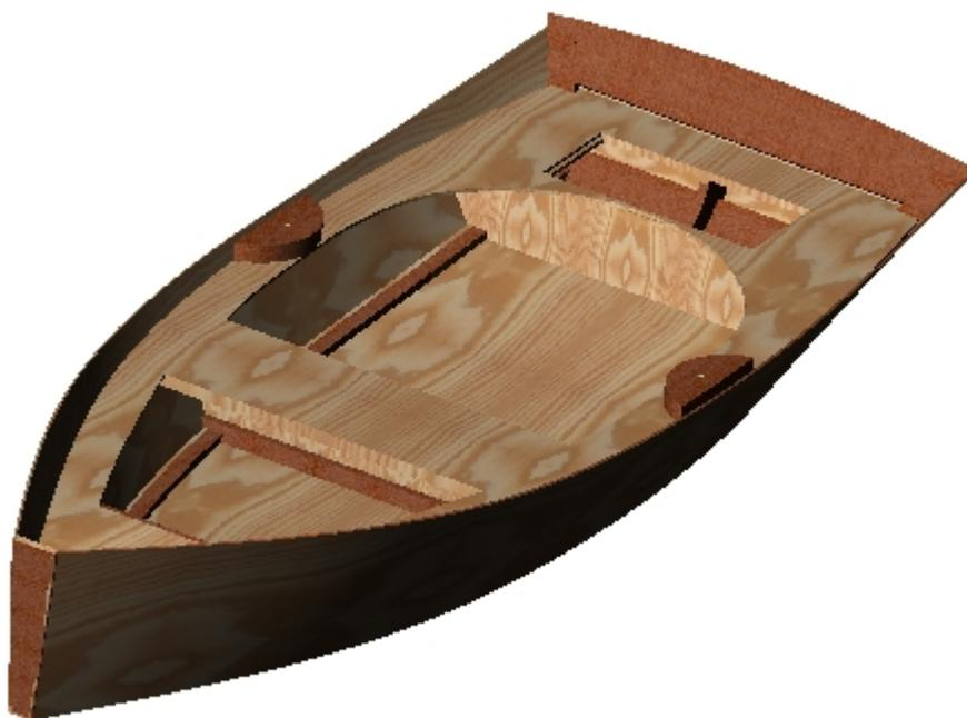
*Рис.18. Обшивают борта крепится на клею и саморезах к днищевым стрингерам и стрингерам палубы.*
