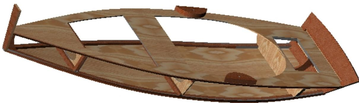
*Рис.17. Монтируется доска на транец и подушки под уключины. Расстояние уключин от кормового края средней банки должно быть около 300мм. Днищевые стрингеры и стрингеры палубы малкуются для установки обшивки борта. Правильность малковки проверяют, прикладывая к бортам обрезок фанеры размером 400x1000мм*
