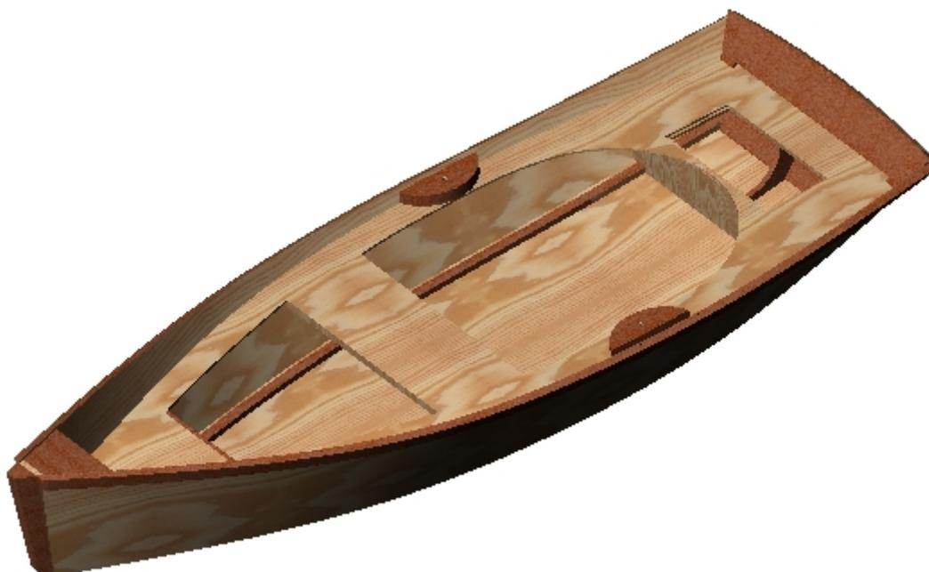
*Рис.19. Монтируют накладку на форштевень (из целого бруска или из двух обрезков досок 25мм). Накладку обообатывают заподлицо с днищем и бортами. Со стороны днища делают небольшое скругление. Монтируют наружные привальные брусья и планшири.*
