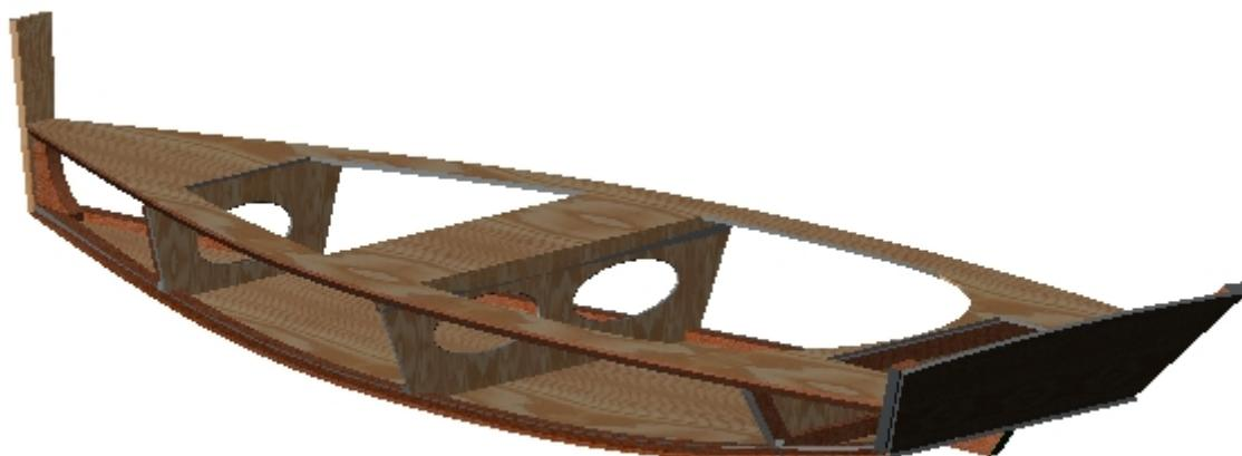
*Рис.16. Установка палубы. Палуба крепится к кнопу в носу и рейке на транце. Продольные рейки палубы должны войти в пазы на шпангоутах. Затем шпангоуты выравнивают и крепят к ним палубу на клею и саморезах.*
