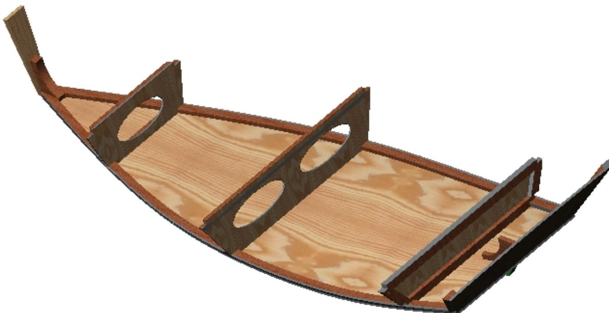
*Рис.15. Установка переборок . Вид с кормы.*
