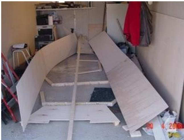
Построение опытного образца плоскодонки проходит хорошо! Листы фанеры были состыкованы, собраны шпангоуты и транцы. Сборка корпуса началась
