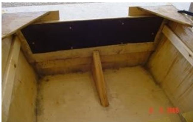
И такие же усиления в кормовом транце. Накладки между бортами и транцем, между днищем и транцем, усиление для веса и толчков от подвесного двигателя.
